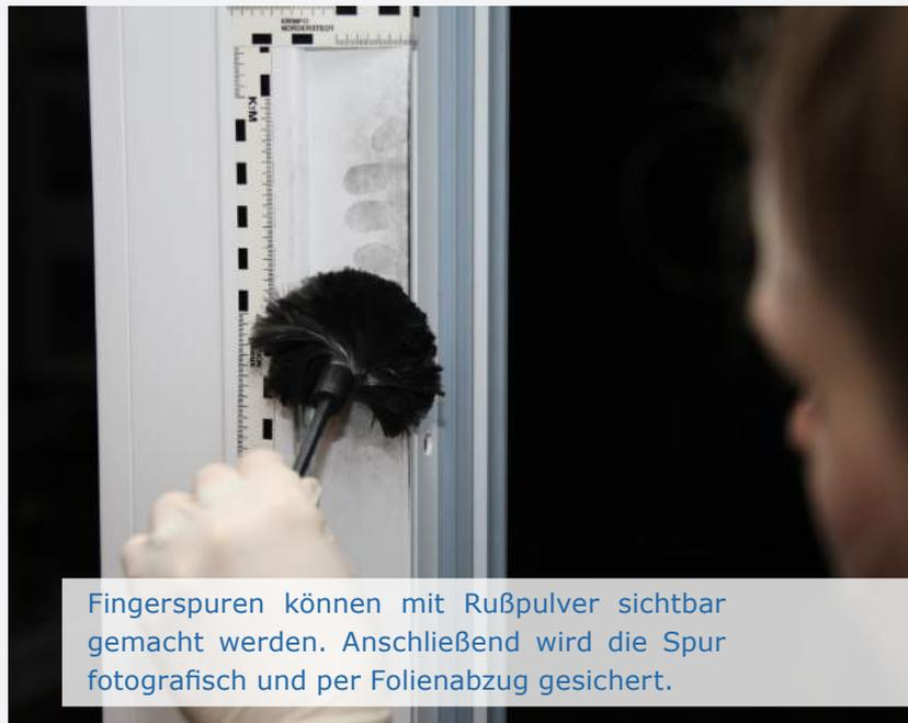
Fingerspuren können mit Rußpulver sichtbar gemacht werden. Anschließend wird die Spur fotografisch und per Folienabzug gesichert.
